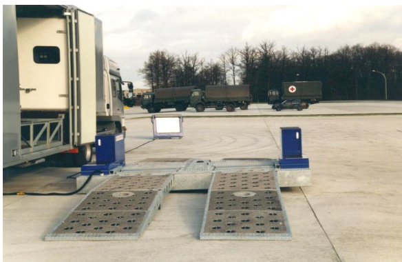
Abb. 15: Niveauregulierung und Anzeige
